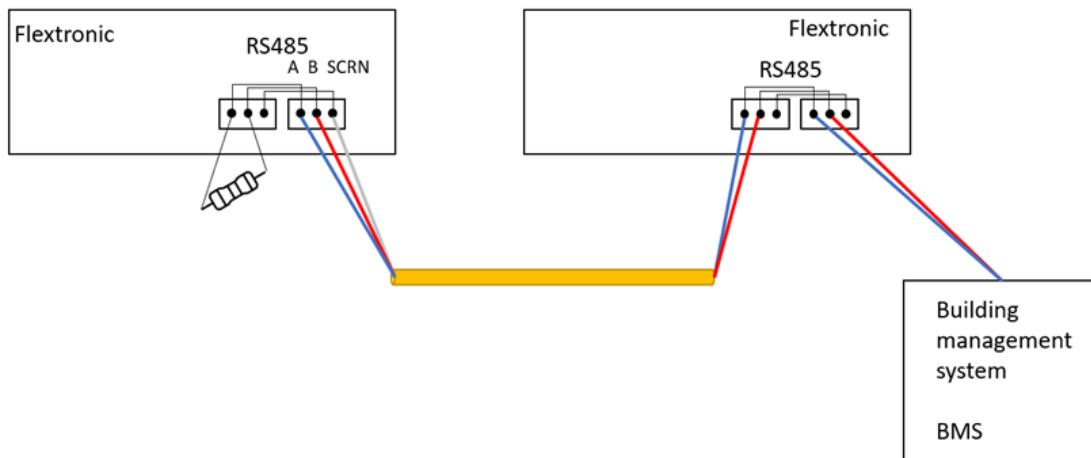
Na RS-485 BUS ni možna hkratna komunikacija preko Modbusa in BACneta. Če sta potrebna oba protokola, mora eden od protokolov teči preko povezave ethernet (IP).
