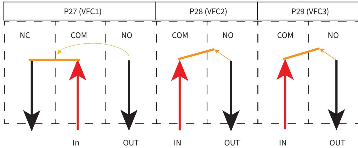
Za pridobivanje stanja avtomata. Poljubno nastavljivo sporočilo o napaki lahko dodelite vsakemu izhodu. Izhod P29 je zaporni signal kotla v načinu  $>110^{\circ}\text{C}$ , v tem načinu ni na voljo za alarmiranje.
